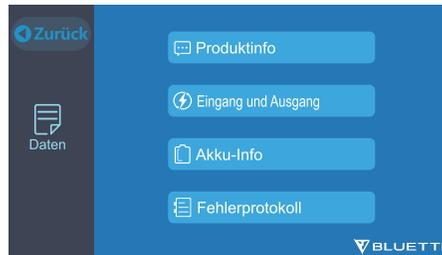
**Note:** 'Input & Output' gibt den Eingangs- und Ausgangsstatus dieses Geräts an; 'Batterieinformationen' gibt den Verbindungsstatus des/der Batteriepacks/Akkupacks an; 'Alarm History' zeichnet alle generierten Alarme auf, die manuell gelöscht werden können.
